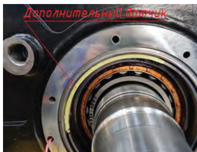
Рисунок 2 – Дополнительный датчик температуры
