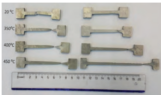
Рисунок 4 – Образцы сплава 1565ЧМ после испытаний на растяжение при различных температурах нагрева основного металла (слева) и сварного шва (б). Лист толщиной 8 мм
