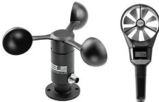
Рисунок 3. Анемометры: чашечный (слева); крыльчатый (справа)
