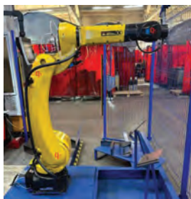
Рис. 4. а – манипулятор Fanuc M - 20iD / 25 на рабочей позиции, б – траектория движения фланца манипулятора под действием импульсного воздействия
