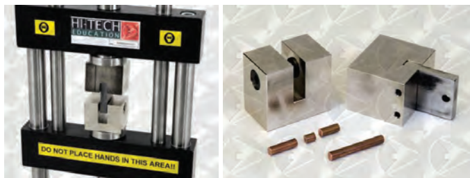
Рис.2: Испытательная установка HSM58 Universal Material Tester
