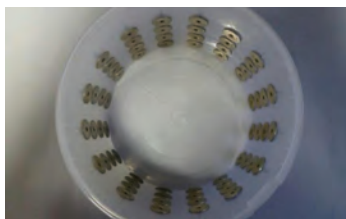
Рисунок 1 - Внешний вид разработанной 3 - х поясной системы для ЭИТ с 16 электродами в каждом поясе
