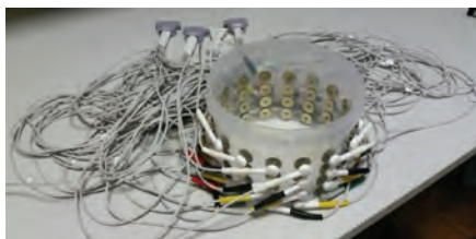
Рисунок 1 - Внешний вид разработанной 3 - х поясной системы для ЭИТ с 16 электродами в каждом поясе
