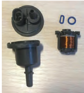
Рисунок 1 - Клапан адсорбера в разобранном виде
