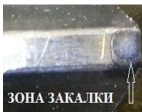
Рисунок 2 - Фрагмент зуба фрезы в осевом сечении из инструментальной стали P18K5Ф2, обработанного в режиме закалки без оплавления.
