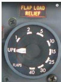
Рисунок 7 – Индикация Flap load relief
