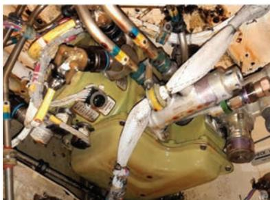
Рисунок 6 – Блок управления закрылками
