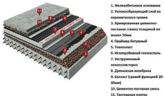
Рис. 1. Кровельный пирог инверсионной плоской кровли. [7]
