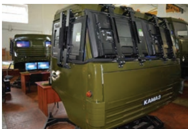
Рисунок 1 – Динамический тренажер КАМАЗ 5350 (модуль водителя - имитатор кабины автомобиля «КамАЗ»)
