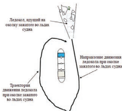
Рисунок 1. Процесс околки ледоколом зажато льдом судна
