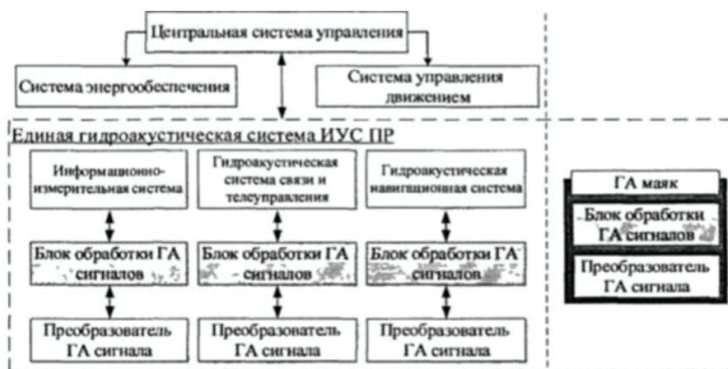
Рисунок 1 – Единая гидроакустическая система ИУС ПБА
