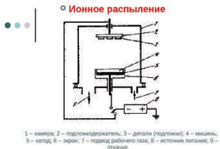
Рис. 1. Принципиальная схема распыления
