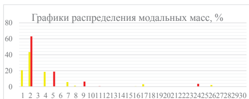
Рисунок 7 – График распределения модальных масс, %
