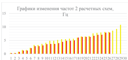
Рисунок 6 – График изменения частот от сейсмического воздействия для четырех схем, Гц
