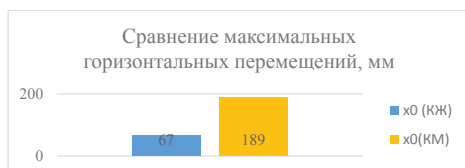
Рисунок 5 – Максимальные горизонтальные перемещения в схемах, мм
