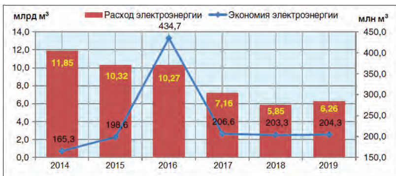
Рисунок 3 – Динамика потребления электроэнергии на СТН и экономии электроэнергии при транспортировке газа в 2014 – 2019 гг. [1]
