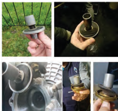
Рисунок 1 - Конструктивная заводская недоработка или использование при сборке оборудования некачественного материала
