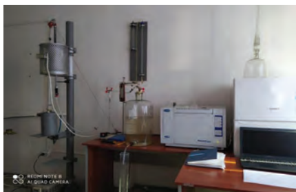
Рисунок 4 – Экспериментальная установка по исследованию адсорбции
