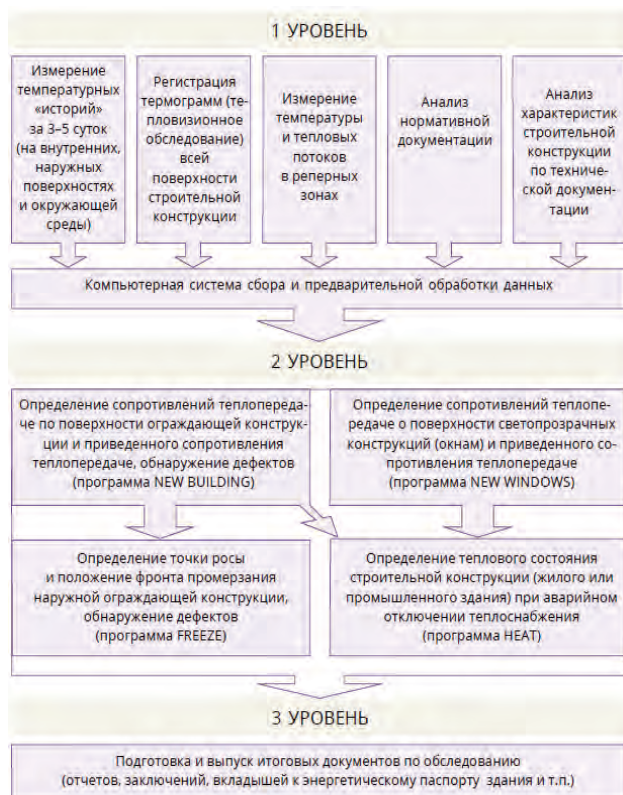
Рисунок 1 – Структурная схема комплексного тепловизионного контроля зданий и строительных конструкций (в летний и зимний периоды) [3]
