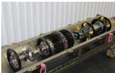
Рисунок 2 – Внутритрубные магнитные сканеры: КОД - 4М
