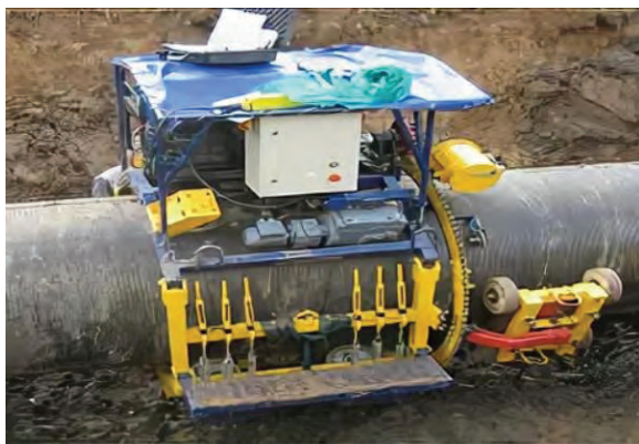
Рисунок 3 – Магнитные сканирующие дефектоскопы DNC 1200
