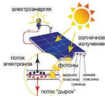
Рис.1. Конструкция солнечного элемента
