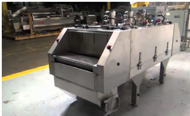
Рисунок 2 – Внешний вид установки для криоконсервирования сырья жидким диоксидом углерода
