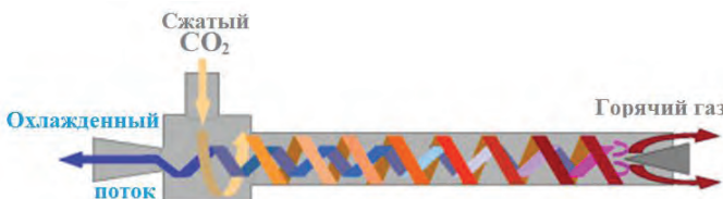
Рисунок 1 – Устройство трубы Ранка - Хилша
