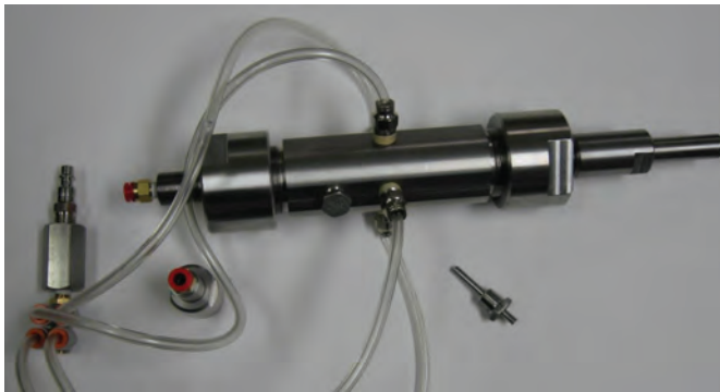
Рис. 4. Устройство для аэродинамического смешивания и активации топливной смеси в состоянии поставки от изготовителя к потребителю
