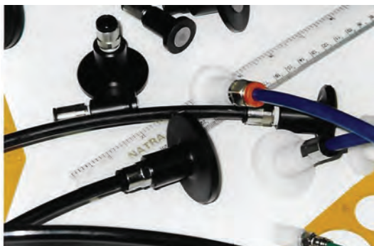
Рис. 5. Варианты аэродинамических захватов для роботов, в этом же дизайнерском варианте, являющиеся также и аэродинамическим генератором пены
