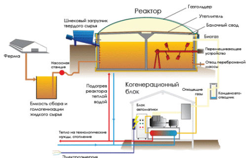
Рисунок 1. Схема работы биогазовой установки
