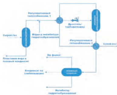
Рисунок 1. Типичная схема установки низкотемпературной сепарации (НТС)
