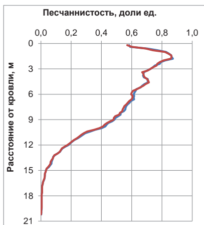
Рисунок 1.6 - Геолого - статистический разрез по РИГИС и геологической модели.
