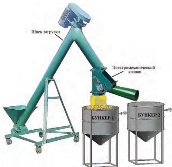
Рисунок 1 – Технологический процесс линии загрузки зерна в два бункера
