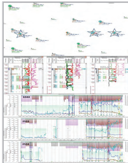
Рисунок 1 – Выкопировка из карты текущего состояния разработки по состоянию на 01.10.2009 г., геологический разрез скважин №№ 6340 - 2533 - 2534, технологические показатели работы скважин №№ 6340, 2533, 2534
