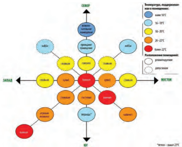
Рисунок 1. Схема расположения помещений с учетом господствующей в них температуры и возможности поглощения ими солнечной энергии в зависимости от сторон света.
