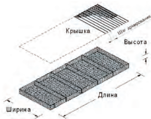
Рис. 3. Усиленная (армированная) габионная конструкция с крышкой для применения при ледовых и волновых воздействиях
