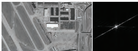
Рис. 2. Восстановленное изображение со сверхразрешением с его ПЧС при выполнении подавления ФРТ на инспирированных изображениях
