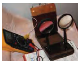
Рисунок. 5. Солнечный термоэлектрический генератор (макет)
