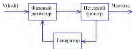
Рис.1. Оценка частоты с использованием фазовой автоподстройки
