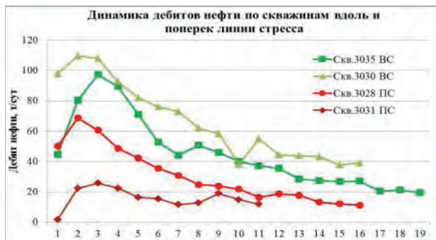
Рисунок 4. Объект ЮВ 1 . Сопоставление динамики показателей по горизонтальным скважинам, размещенным вдоль и поперек стресса
