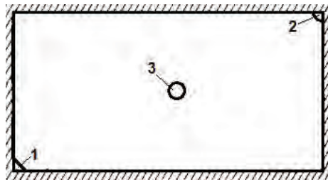
Рисунок 1 – Элемент трехрядной системы разработки; 1 – четверть нагнетательной скважины; 2 – четверть добывающей скважины; 3 – добывающая скважина.
