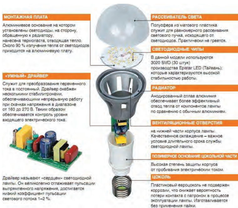
Рисунок 1. Конструкция светодиодной лампы [1]
