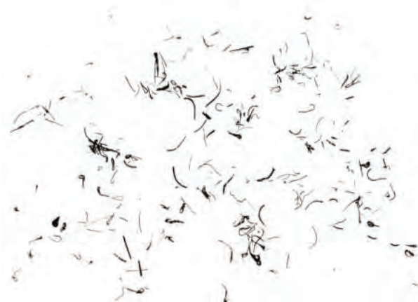
Рисунок 2 – Различные неволоконистые включения, выпавшие при тряске образца холста из супертонкого базальтового волокна на площади 100 см 2
