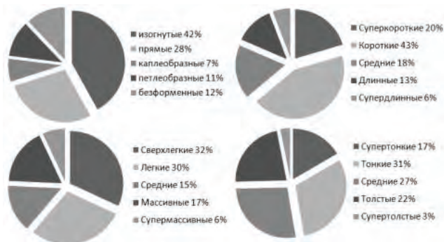
Рисунок 3 – Концентрация неволоконистых включений по различным признакам на площадке 100 см 2
