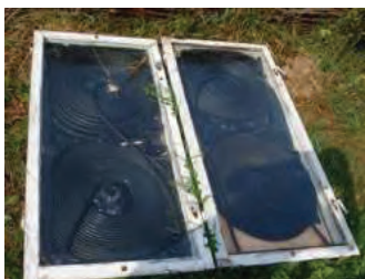
Рисунок 3. Солнечный коллектор на базе садового шланга.
