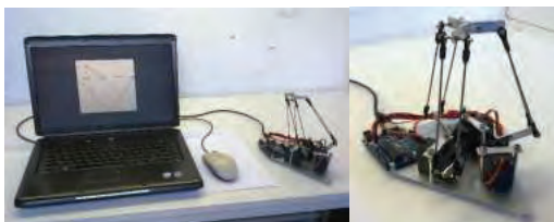
Рисунок 3 - Дельта - робот, управляемый компьютерной мышью
