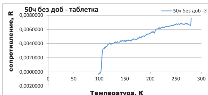
Рисунок 1 – Измерение критической температуры таблетки с добавкой \text{Co}_{0,5}\text{Zn}_{0,5}\text{Fe}_2\text{O}_4 после 50 часового спекания
