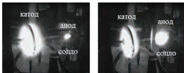
Рисунок 2. Картина свечения тлеющего разряда при давлении 2 торр в неподвижном воздухе (справа) и в сверхзвуковом течении (слева).
