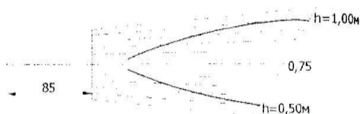
Рисунок 2 – Транспарант для определения дальности полёта удобрений при изменении высоты расположения центробежного диска над поверхностью почвы (85 мм – размер, необходимый для изготовления транспаранта)
