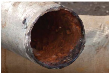
Рисунок 1 – Коррозионные участки, царапины и риски на стенке труб при воздействии различным инструментом
