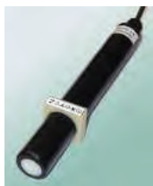
Рисунок 1 – Внешний вид преобразователя индукции магнитного поля трехкомпонентного NB0302
