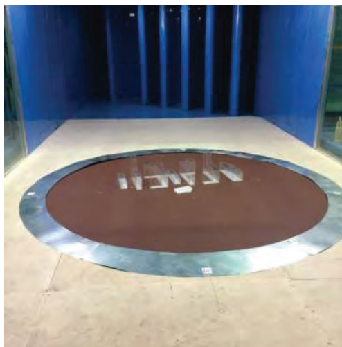
Рис. 3 Макет участка застройки на автоматизированном поворотном столе в рабочей зоне аэродинамической трубы
