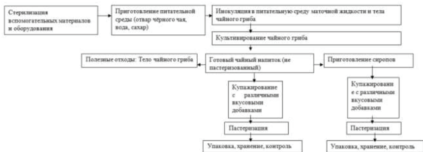
Рис.1. Технологический процесс производства напитка и сиропа чайного гриба
